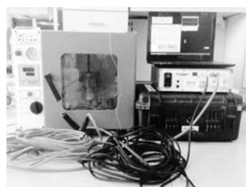
图4 频域介电响应测试系统
